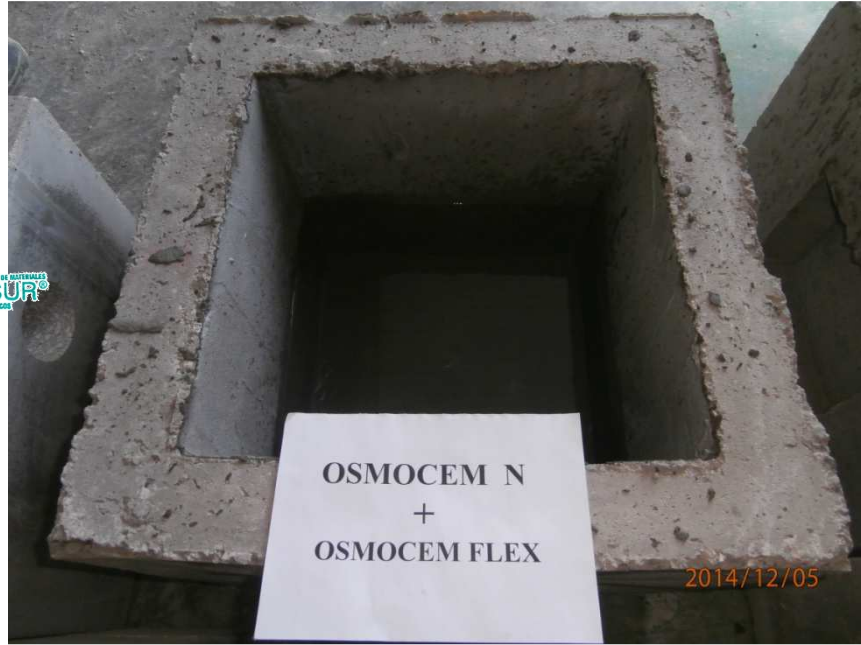
Depósito impermeabilizado con el sistema III: Producto Bicomponente OSMOCEM Flex.
