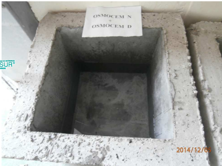
Depósito impermeabilizado con el sistema II: Producto Bicomponente OSMOCEM D.
